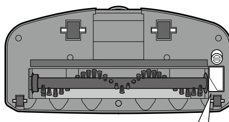
ブラシ押さえ板の取り付けは、ツメをひっかけてから、「カチッ」と音がするまで押し込みます。
