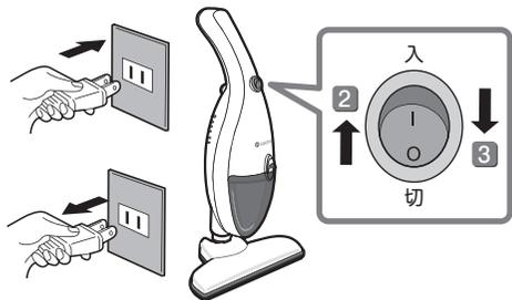
電源スイッチを「I」(入)にしたとき、モーターが回転する反動が手に伝わります。本体を落とさないようにしっかりと持ちながら電源スイッチを操作してください。
