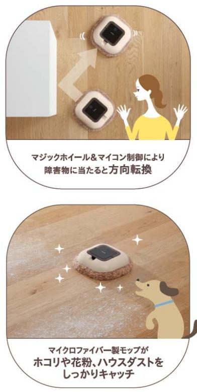
「モーファ」は幅23.5cm×高さ8cmのコンパクトなスクエア型で本体底部にマイクロファイバー素材のモップを装着しています。マジックホイール＆マイコン制御で障害物に接触すると自動で方向転換し、フローリングの床面をモップ掃除します。薄型設計によりソファやベッドの下にも入りこみ、壁際にたまつたホコリも吸着します。約2時間の充電で最大1.5時間稼働（30分タイマー付き）します。カバーは水洗いできますので繰り返しお使い頂けます。30分で自動オートオフするタイマー機能付き、通常モード（約6-8畳）と小部屋モード（約4.5~6畳）のお部屋の広さに合わせた2つのモードを選択でき、ON/OFF切替え可能なサウンド機能も搭載しています。
