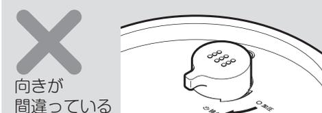
※圧力調整ツマミが正しく取り付けられていないと、加圧調理時に蒸気が漏れ、正しく調理されません。
