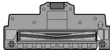
ブラシ押さえ板の取り付けは、ツメをひっかけてから、「カチッ」と音がするまで押し込みます。
