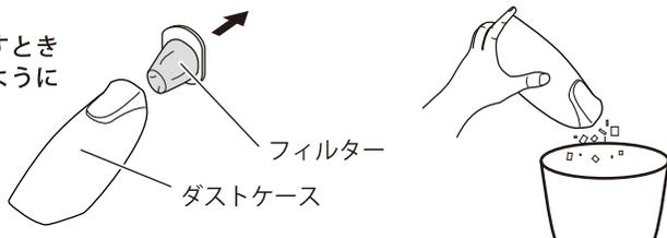
3 フィルターをダストケースに取り付けてからダストケースを本体に取り付けます。(フィルターが正しく取り付けられていないとダストケースが本体に取り付けられない原因になります)
