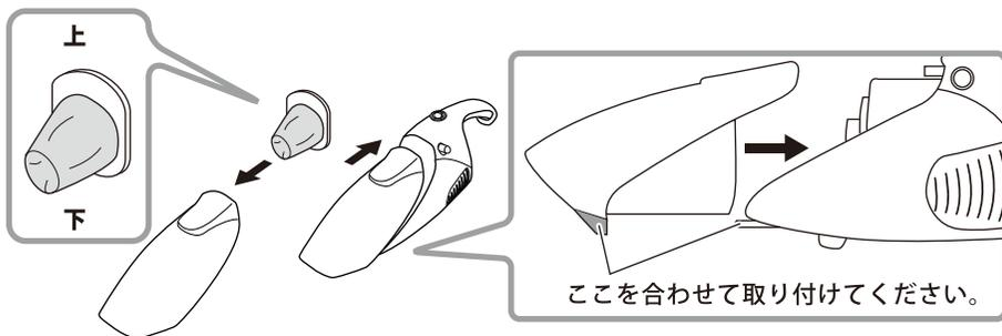
フィルターは必ず取り付けてください。フィルターを取り付けずに使用すると故障の原因になります。
