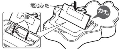
※タイマーの音が小さくなって聞きとりにくくなったり、音が止まるなどする場合や、液晶表示部が暗くなった場合また、各ボタンが反応しない場合は、すべて新しい電池に交換してください。
