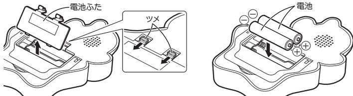
③ 電池ふたの凸部を差し込み、カチッと音がするまで押し込む
