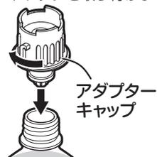
③アダプターキャップを取り付けた後、ペットボトルをさかさまにしてペットボトルを軽く押しもアダプターキャップの根元から水漏れがないことを確認します。
