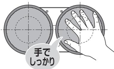
モップパッド取り付け目安線に合わせて、しっかり貼り付ける。
