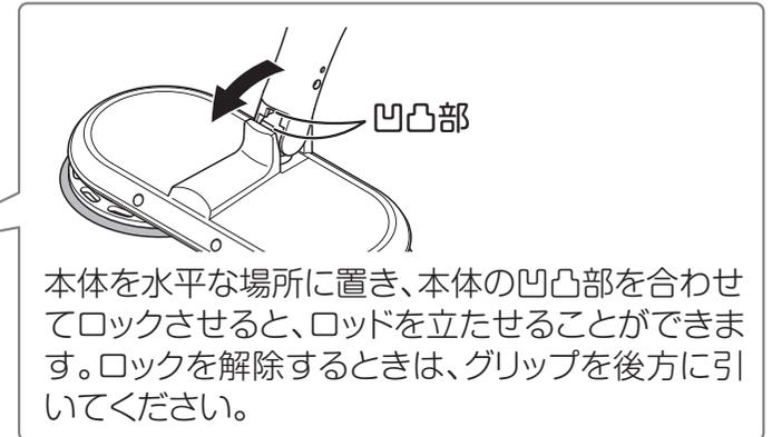
本体を水平な場所に置き、本体の凹凸部を合わせてロックさせると、ロッドを立てせることができます。ロックを解除するときは、グリップを後方に引いてください。
