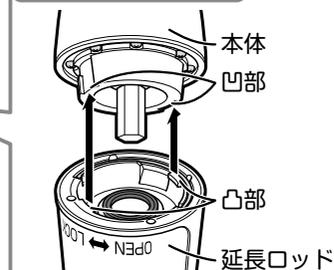
①本体の凹部に延長ロッドの凸部を合わせて差し込みます。
