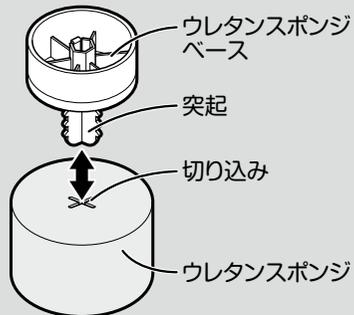
ウレタンスポンジ（交換用）の切り込みとウレタンスポンジの突起の形状を合わせて取り付けてください。
