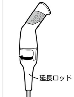
②延長ロッドを矢印の方向 (LOCK側)にまわしてロックします。
